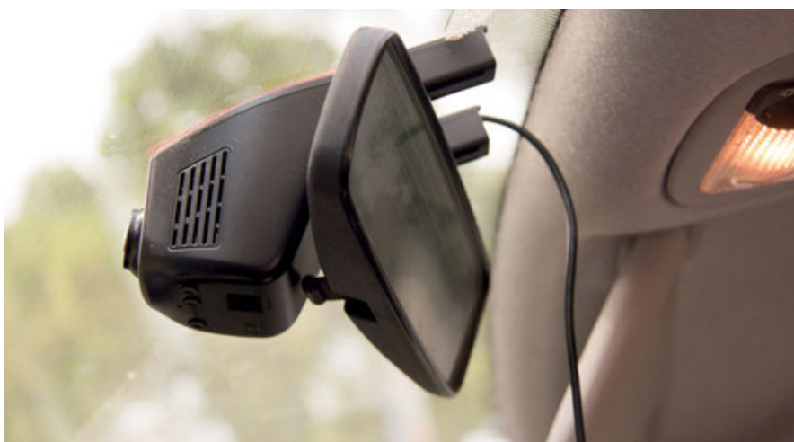
La dashcam installata a bordo secondo le indicazioni del costruttore. Non in tutte le auto può essere installata senza qualche adattamento.
