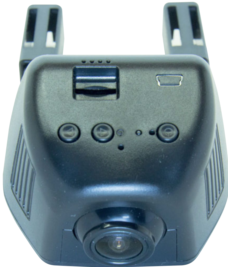
Sulla parte anteriore sono presenti i pulsanti per il controllo delle funzioni principali, in particolare accensione ed attivazione del wi-fi. Accanto, lo scomodo (ma sicuro) slot per la scheda di memoria.
